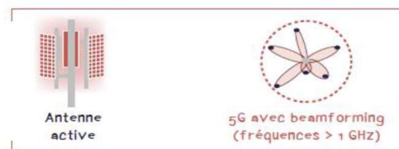
Nouvelles antennes 5G
